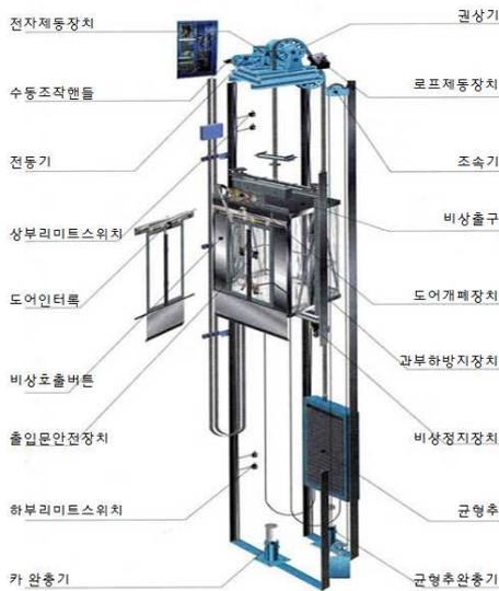
그림 1. 승강기 시스템 구성 요소
