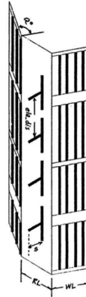
그림 1. 코너 반사판 안테나의 구조 Fig. 1. Cinfiguration of the corner reflector antenna.
