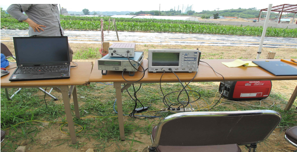
그림 8. 접지임피던스 측정시스템의 외관 사진 Fig. 8. Outside view of the grounding impedance measuring system
