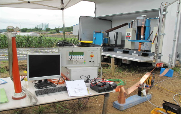
그림 9. 과도접지임피던스 측정시스템 외관 사진 Fig. 9. Outside view of the transient grounding impedance measuring system
