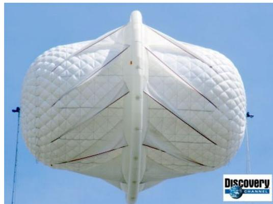
그림 2. Magenn Power 10kW 고공 풍력발전기
