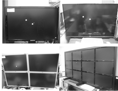
[그림 2] 실험에서 사용된 디스플레이: 24인치 모니터(왼쪽 상단), 50인치 모니터(오른쪽 상단), 2x2 타일드 디스플레이(왼쪽 하단), 4x3 타일드 디스플레이(오른쪽 하단)
