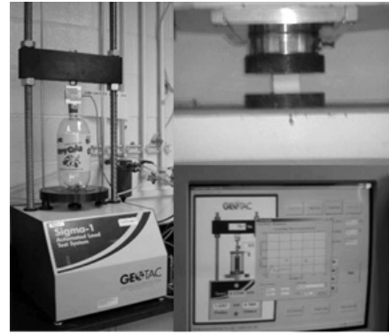
그림 5. Geo-Bottle과 EPS(D-20) 압축강도시험
