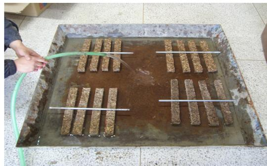
그림 5. 침수된 시험체 모습
