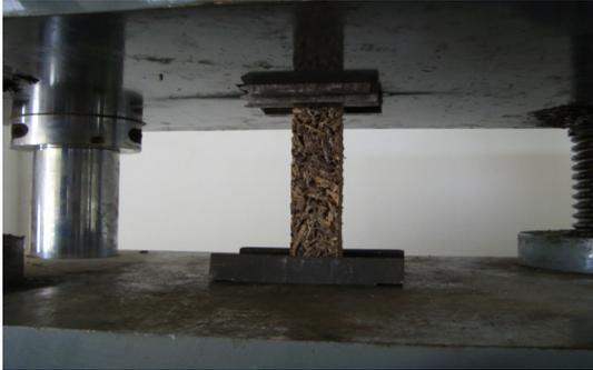
그림 2. 인장강도 시험
