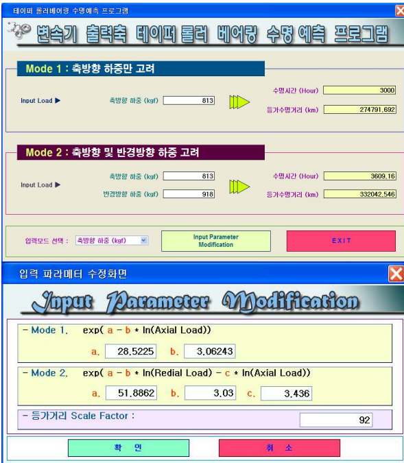
그림 9 변속기 출력축 테이퍼롤러 베어링 수명 예측 프로그램 화면
