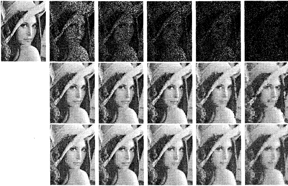
그림 4.1. 랜덤결측 비율에 따른 대체 결과(첫 줄: 원영상 및 50%, 60%, 70%, 80%, 90% 결측 영상, 둘째 줄: CSI에 의한 대체 영상, 셋째 줄: 제안된 방법에 의한 대체/복원된 영상)
