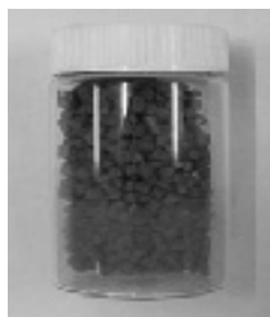
Fig. 3. 메탄올 분해 촉매. (Sud-Chemie KMA RS)
