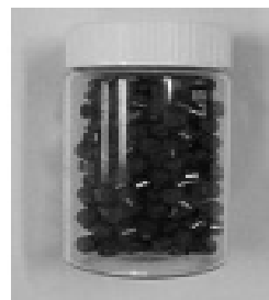
Fig. 2. 메탄올 합성 촉매. (Sud-Chemie MegaMax 700. C79-7)
