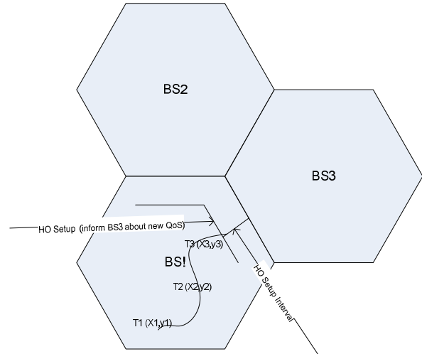
그림 1. 목적지 기지국으로의 예측 핸드오버시 궤적 Fig. 1. Trajectory used for prediction of destination base station and handover time in advance
