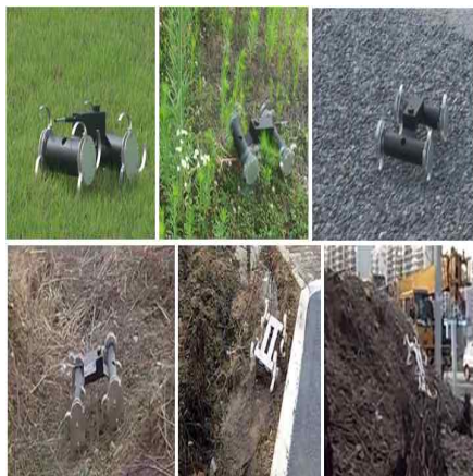
그림13. 정찰 로봇의 다양한 환경 테스트 Fig13. Field Test of Patrol Robot
