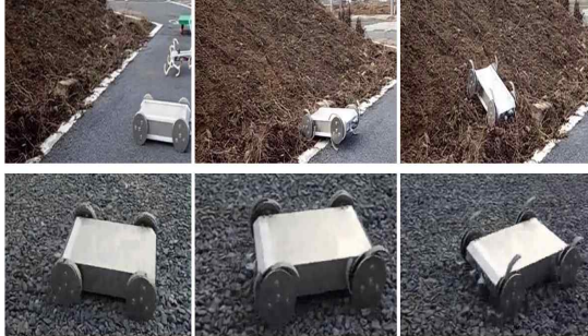
그림15. 순응형 가변 구동 정찰 로봇의 구동 테스트
