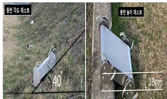
그림14. 순응형 가변구동 로봇의 등반 각도 및 높이 극복 시험 Fig14. Slope Test of self-adaptive variable wheel
