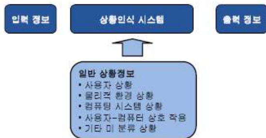
그림 2. 상황인식 시스템 개념도 Fig. 2. Concept of context-aware system.
