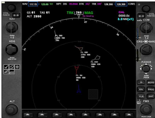
그림 5. CDTI 기능을 제공하는 ND 프레임 Fig. 5. ND frame with CDTI function.
