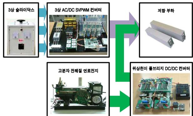
그림 10. 제안된 시스템의 실험세트 구성
