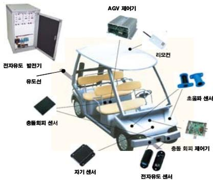
그림 1. 전자유도 골프카트의 시스템 구성
