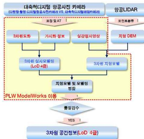
그림 9. PLW Model Works를 이용한 3차원 공간정보 제작 과정
