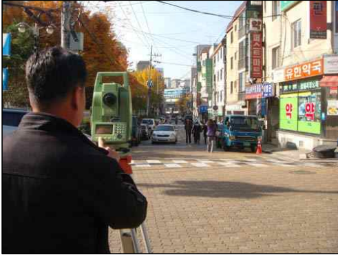
그림 4. 폭 7m 도로에서의 TS관측
