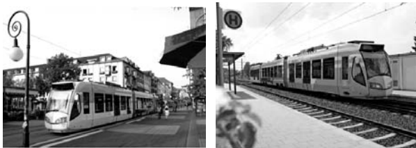
그림 3. 트램트레인 형식의 차량인 Alstom Regio-Citadis의 도심 노면궤도 주행과 외곽 철도 주행 모습
