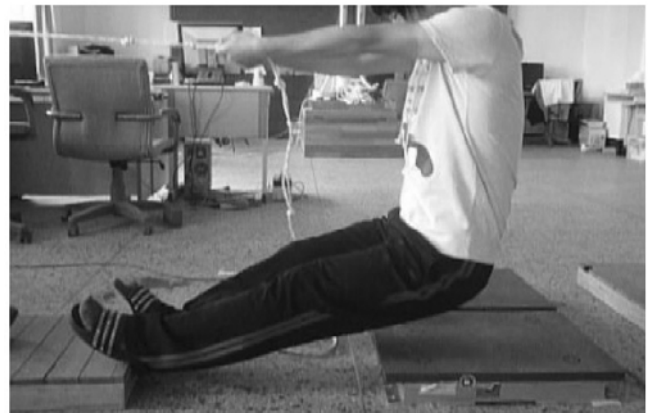
그림 4. 충격량 측정 실험 Fig. 4. Contact force measuring experiment on force plate
