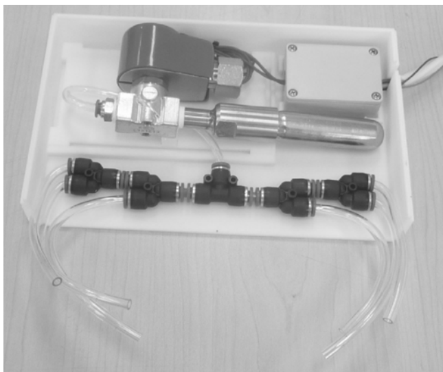
그림 15. 가스 분출 장치의 내부 구조 Fig. 15. Internal structure of fracture prevention system
