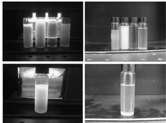
그림 3. 합성된 CdSe 나노입자들의 자외선 하에서의 사진 (왼쪽)과 백열등 하에서의 사진(오른쪽).
