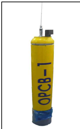
Fig. 4. Fabricated autonomous float 그림 4. 제작된 자율 뜰개
