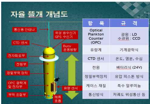
Fig. 1. Key map of autonomous float 그림 1. 자율뜰개 개념도
