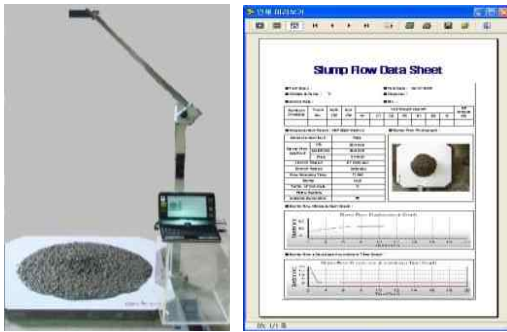
Fig. 2. Measurement system using camera 그림 2. 카메라 이용 측정 장치
