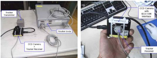
(그림 3) 실험에 사용된 CCD 카메라 및 3차원 좌표 추적기
