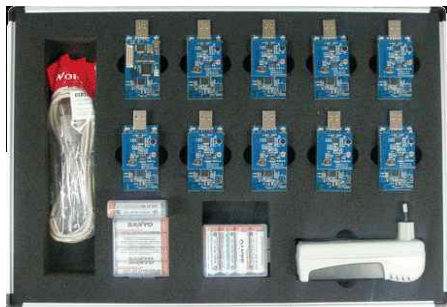
(그림 4) 무선 센서네트워크 시스템(Hmote-ZigBee)
