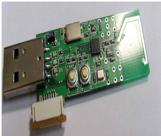
(그림 6) 산소 포화도 무선통신 모듈 사진 Fig. 6 wireless com. module image of SpO2 signal
