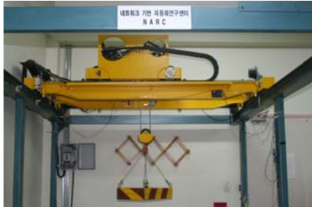
그림 9 천정형 크레인 사진 Fig. 9 Photograph of overhead crane
