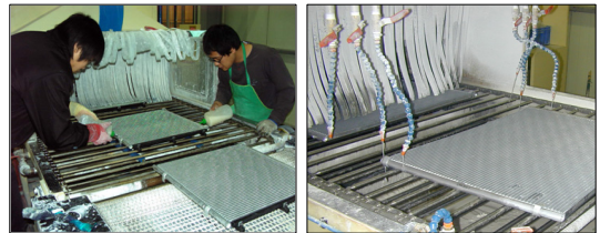
(a) 수작업 도포 (b) 자동 도포
