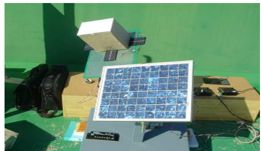
그림 5. 태양 추적시스템의 실험장치 Fig. 5. Experimental equipment of sun tracking system
