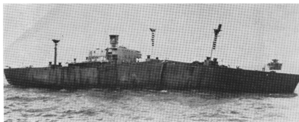
그림 5 수중폭발 버블 펄스에 의한 함정 종강도 상실 예
