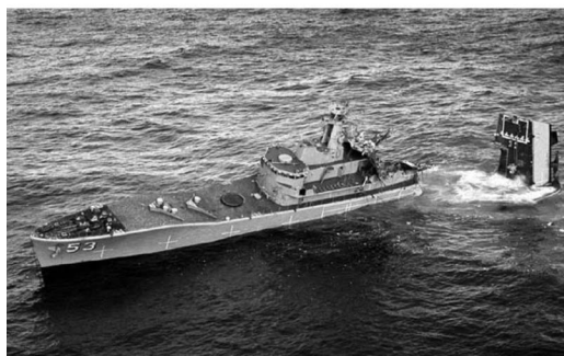
그림 6 근접 수중폭발에 의한 함정 침몰손상 예
