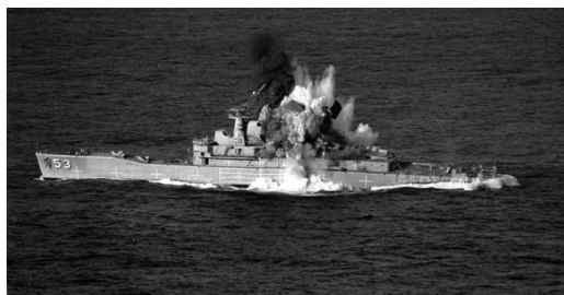
그림 5 수중폭발 버블 펄스에 의한 함정 종강도 상실 예
