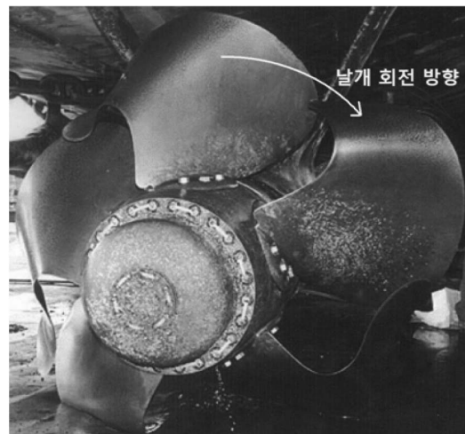
그림 2 우현 프로펠러 날개의 변형 형상 및 날개의 회전 방향
