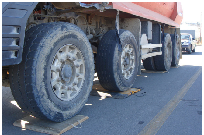
그림 2. WIM시스템 본체 및 설치된 센서
