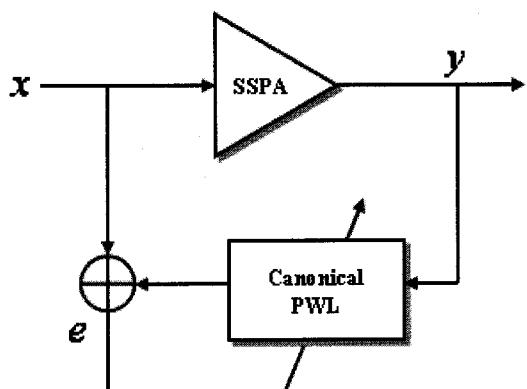
그림 9. SSPA의 역 모델링 실험 구성도
