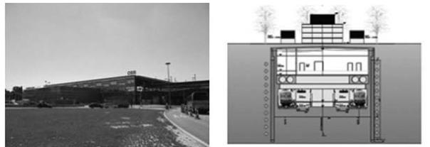
그림 15. 오스트리아 U-Bahn Praterstern역의 지열을 이용한 냉(92kW)/난방(154kW)
