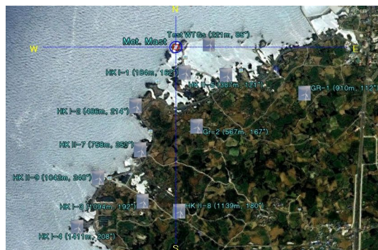
그림 2. Met Mast에서 본 각 방위별 장애물 분포도
