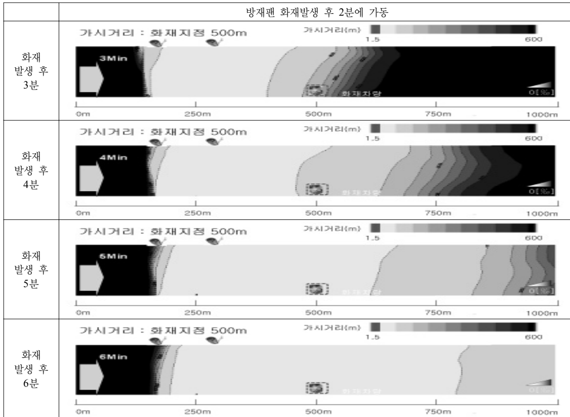
그림 9. 화재지점 500 m, 화재발생 2분후 가동시 가시거리가 20 m 이하(상류) 구간분포(방재팬 입구 4대 설치)
