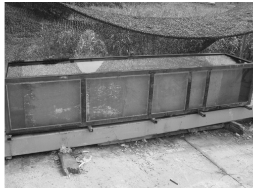
(f) 거푸집 제거후 투수시험용 시료 포화 모습
