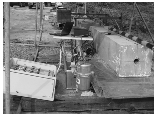
그림 5. 모형실험에 사용한 기밀특성 시험장치
