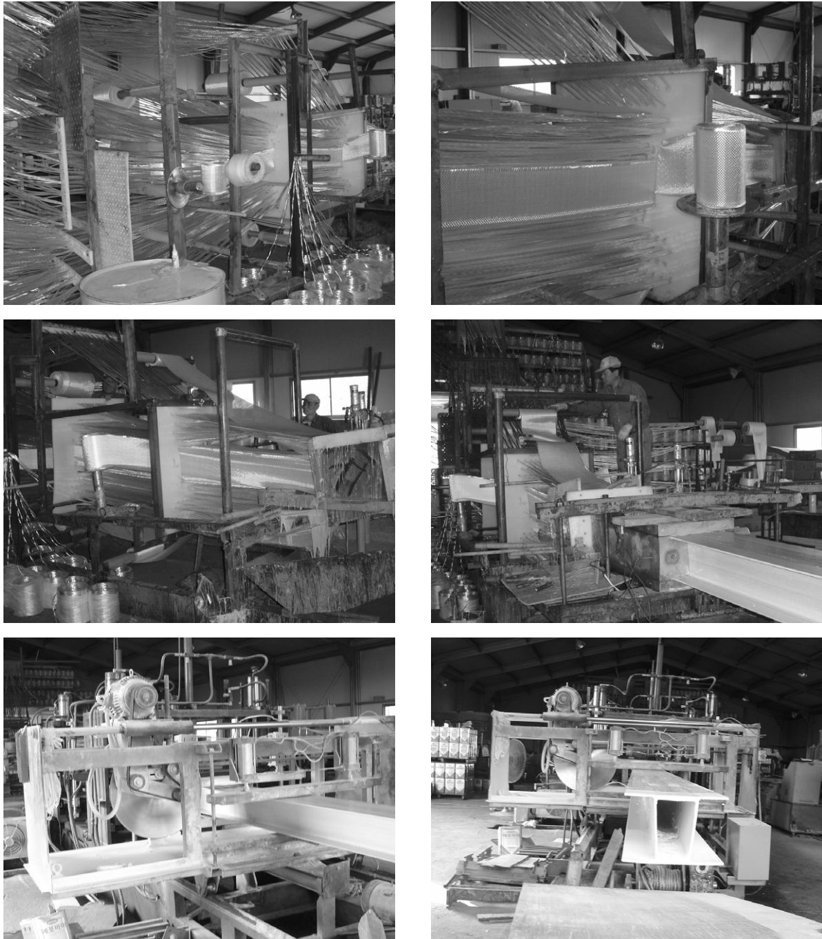
그림 1 복합신소재 단위 튜브 제조과정 (인발공법)
