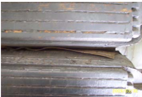
그림 7 회전자 권선 절연물 손상상태 Fig. 7 The damage status of rotor winding insulation
