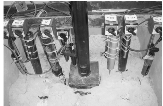
그림 3. LVDT 거치 광경
