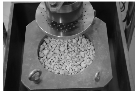
그림 4. 대형직접전단시험 장치 전경
