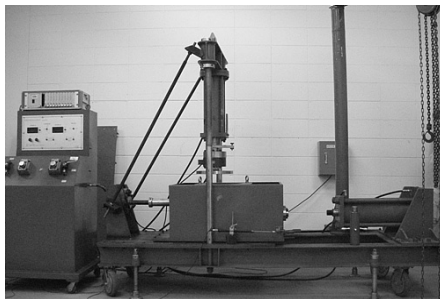
그림 4. 대형직접전단시험 장치 전경
