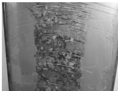
(a) 쇄석다짐말뚝의 Clogging 현상
