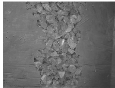
(a) 쇄석다짐말뚝의 Clogging 현상
