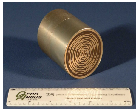
[그림 6] 나선형 기판 후면에 접지된 발룬 (Q-par Angus Ltd. 제공)
