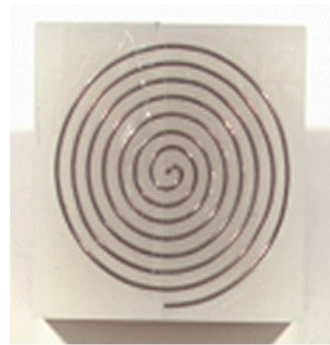
[그림 5] 유전체 위에 좁은 금속면으로 구성된 스파이럴 구조
