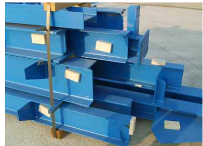
그림 8. 철강에 태그부착 모습 Fig. 8. Tag-attached to Steel
