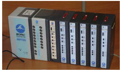
그림 1. 뇌전도 및 심전도 측정 도구 Fig. 1. EEG and ECG Measurement
