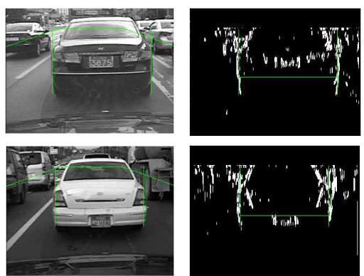
그림 15. 차량 높이 보정 결과 영상. Fig. 15. The result images of modified height of vehicle.
