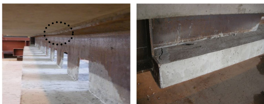
그림13. T500-700-N/N실험체의 국부좌굴 및 슬립
