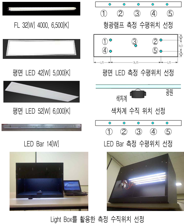
그림 2. 광원의 형태 및 측정위치 Fig. 2. The shape and measurement position of luminaires
