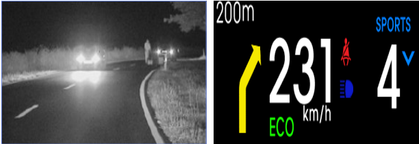
그림 13. 나이트비전 및 운전자 통합 스마트 모니터 이미지 Fig. 13. Night vision (left) and photograph (right) of driver integrated smart monitor system
