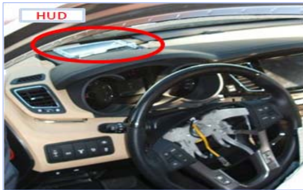
그림 14. 실제 차량에 장착된 HUD 시스템 Fig. 14. Installation to test vehicle
