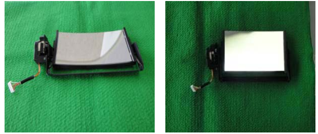
그림 7. 다중초점 곡면미러(좌) 및 평면경(우)의 외형 구조 Fig. 7. The outline of concave mirror (left) and plane mirror (right)
