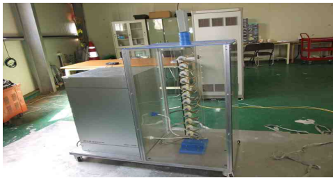
그림 5 모의실험에 사용된 임펄스 제너레이터 Fig. 5 Photograph of the impulse generator used for the simulation test
