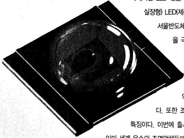
서울반도체가 발표한 LCW100Z1은 기존 CHIP LED의 기판과 달리 메탈기판에 Dome 렌즈를 적용, 광효율을 극대화시켜 120lm/W 이상을 구현하고 열 전달 효율을 높여 Top View 방식의 LED 대비 광효율을 20%이상 향상 시켰다. 특히 이번 제품은 열 전달 효율성 면에서 전류를 2배 이상 훨씬 높일
